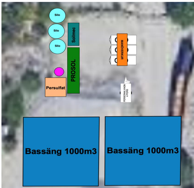
Figur 13. Preliminärt förslag till uppställning av behandlingsanläggningen i kvarteret Antwerpen, lokaliserad över de berggrum där massorna kommer att användas och intill det befintliga schaktet.
